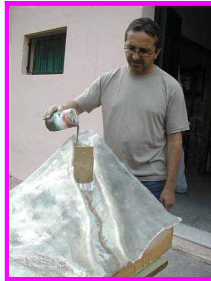
probando la compuerta de la presa
